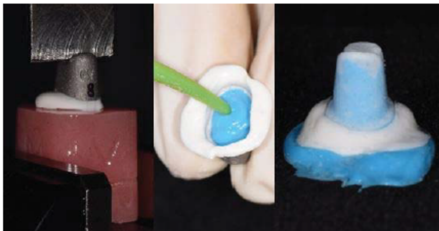
Figura 2. Aplicación del Fit Checker TM Advance.conpresión constante a 50 N en la máquina Instron y obtención de la réplica de silicona.
