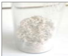
Figura 5. “Sólido” (aceite lubricante adsorbido sobre ulexita)
