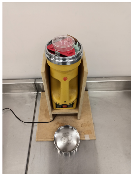
Imagen I. (Izquierda) Equipo SAS SUPER 100 para la toma de muestra de aire en el interior del CDI. (Derecha) Vista del cabezal del equipo.
