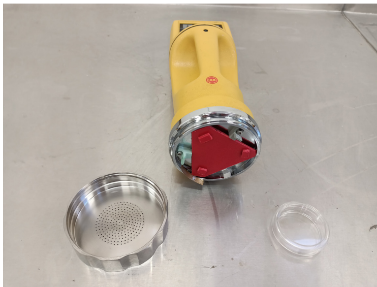
Imagen I. (Izquierda) Equipo SAS SUPER 100 para la toma de muestra de aire en el interior del CDI. (Derecha) Vista del cabezal del equipo.
