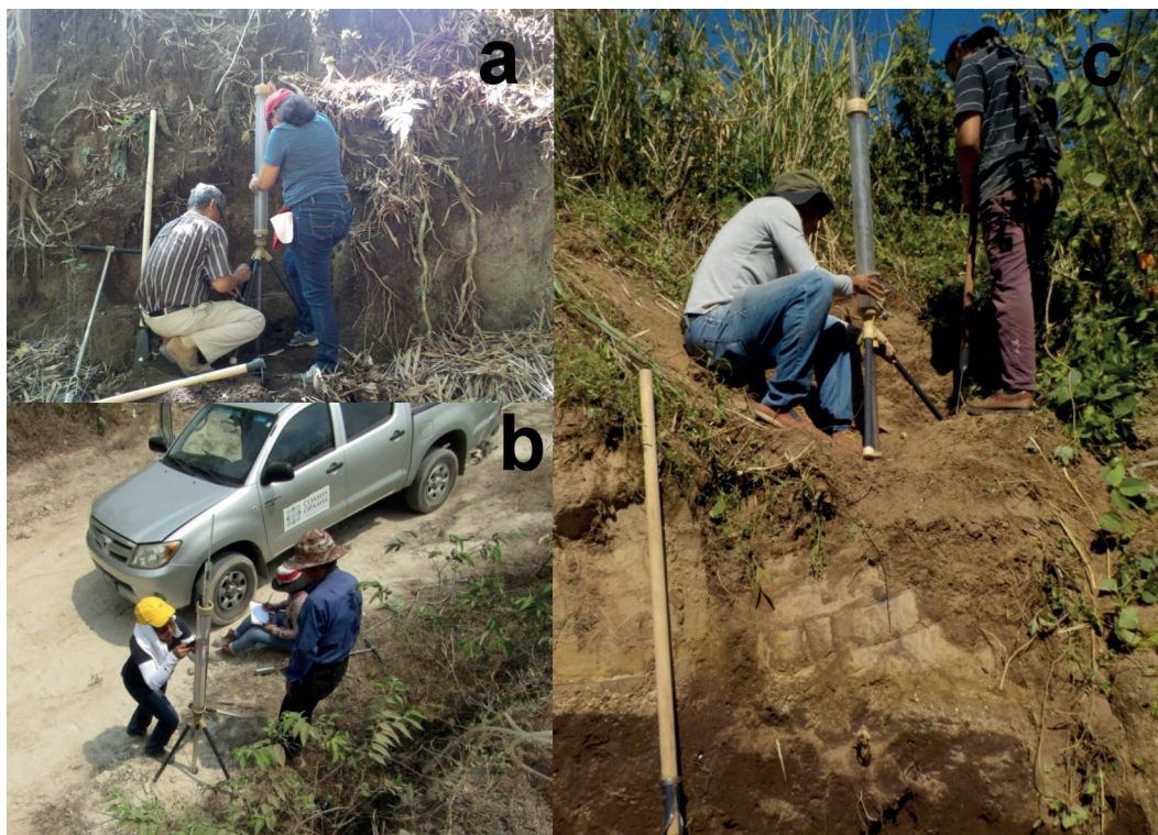
Fig. 4: Pruebas de permeabilidad en campo. En Fig. 1, (a) corresponde a punto 4, (b) a punto 2 y (c) a punto 5 y 6.
