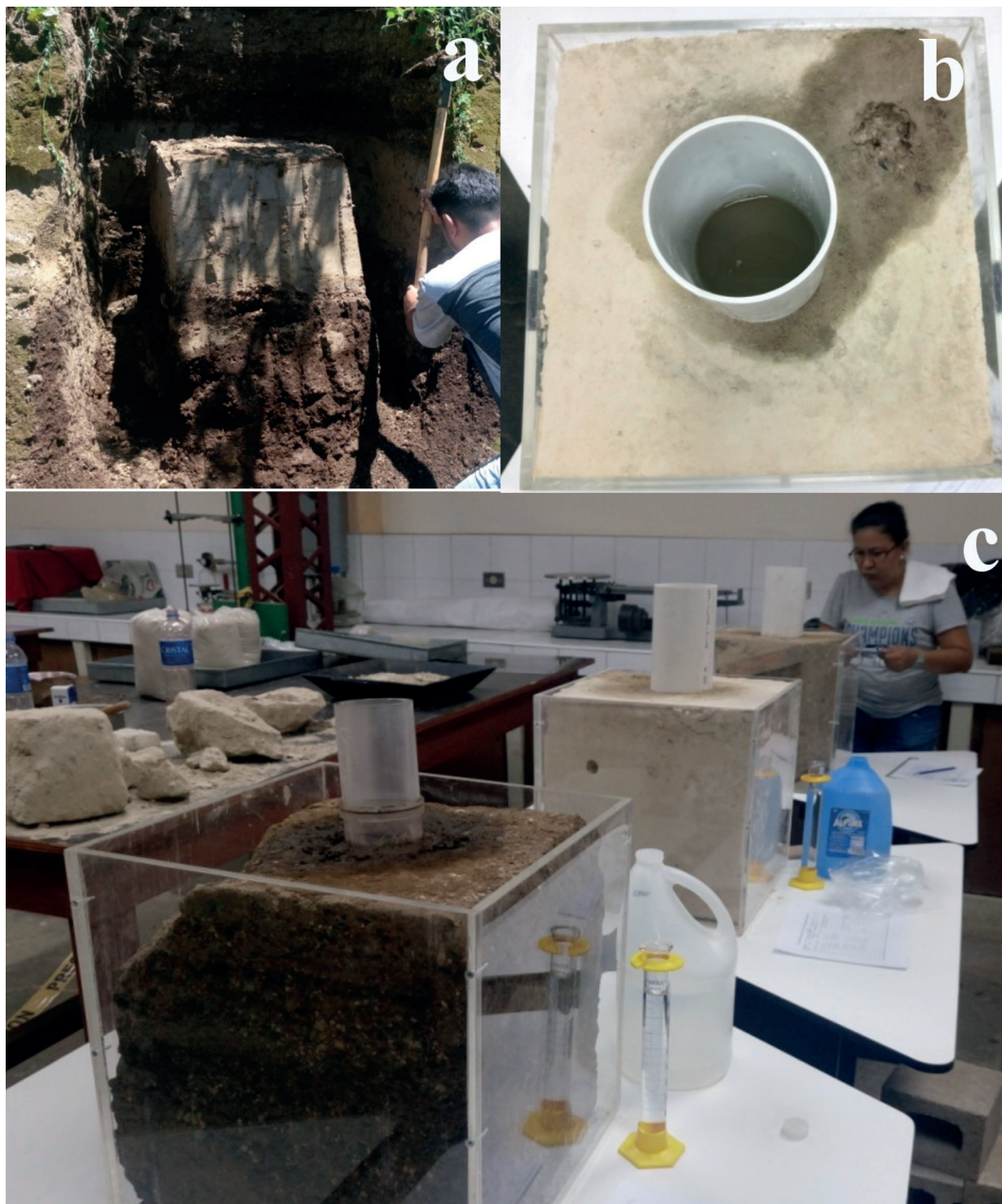
Fig. 3: Preparación (a) y puesta en laboratorio de muestras de suelo en cajas acrílicas para su saturación (b y c).
