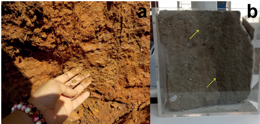
Fig. 6: Movimiento de agua preferencial por medio de raíces. (a) es roca meteorizada en punto 7 de Fig. 1 y (b) es unidad F de TBJ en punto 3 de Fig. 1.
