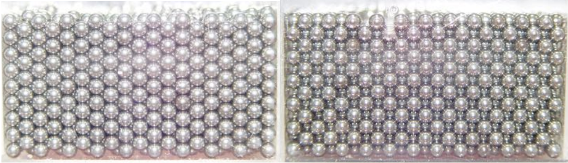
Figura 5. A la izquierda se aprecia una estructura BCC, caracterizada por un centro y seis vecinos; a la derecha se observa una estructura FCC, denotada por un centro y cuatro vecinos. Nótese como relucen los puentes líquidos entre las esferas (derecha).
