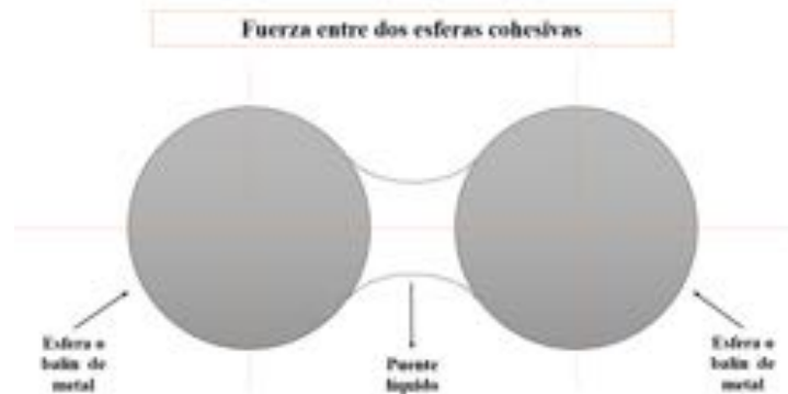
Figura 6. Fuerzas cohesivas entre dos esferas debidas a la presencia de un líquido, lubricante o activador.
