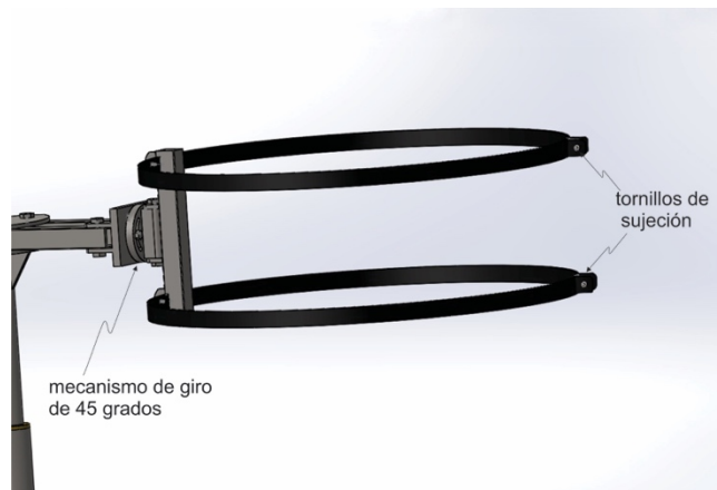
Figura 5. Detalles del diseño de los aros de sujeción
