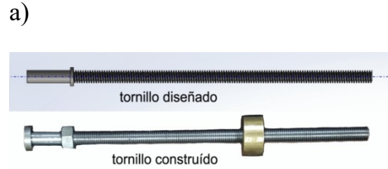
Figura 3. Tornillo de potencia: a) diseñado y b) maquinado.
