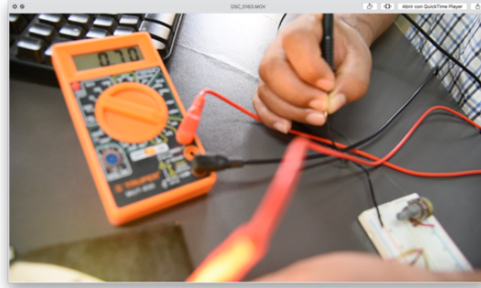
Figura 9: Muestra del consumo de energía del sistema de 0.7 amperios para los tres colores.
