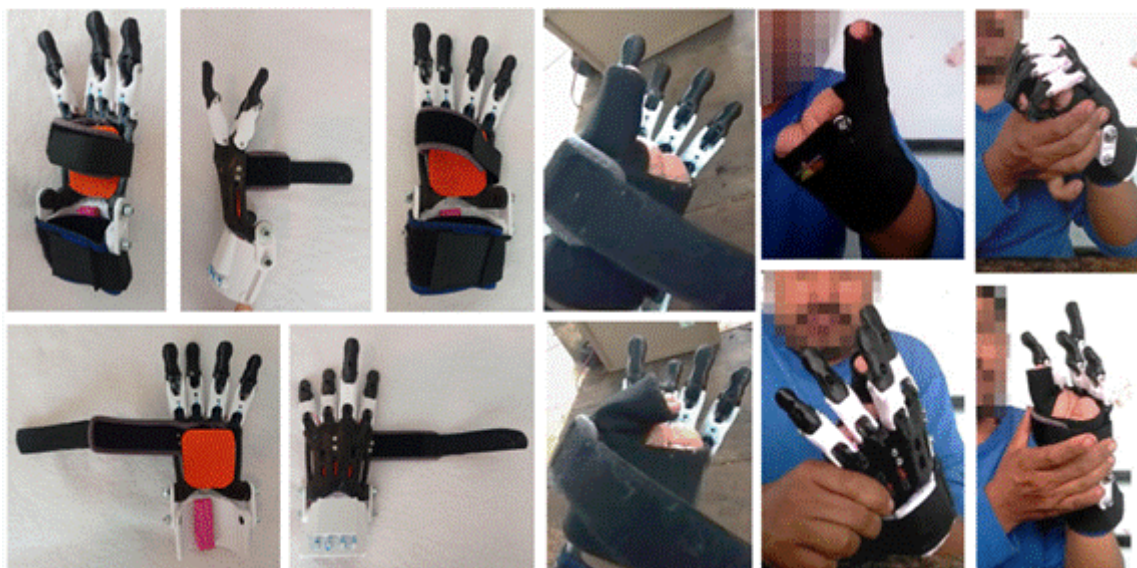
Figura 6. Izquierda. Prótesis experimental ensamblada. Derecha. Usuario en interacción con la prótesis experimental.
