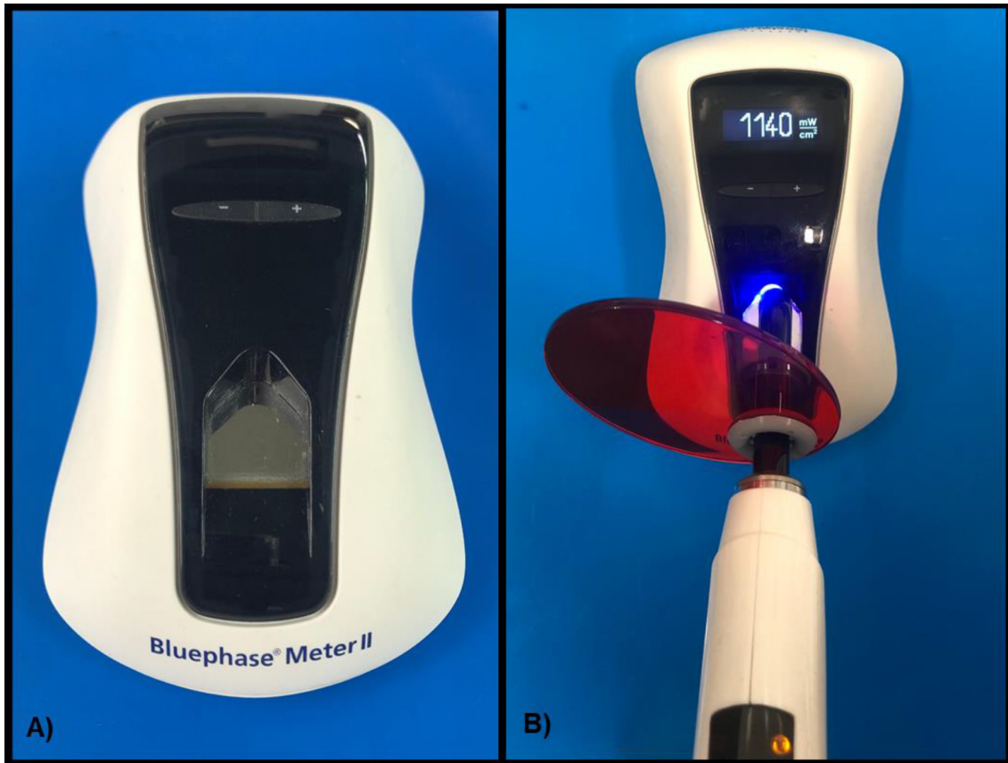
A) Radiómetro digital Bluephase Meter II. Ivoclar Vivadent. B) Medición de la intensidad de luz emitida por una lámpara LED. La intensidad se representa en el visor digital con su unidad de medida correspondiente. Imagen de autoría propia.
