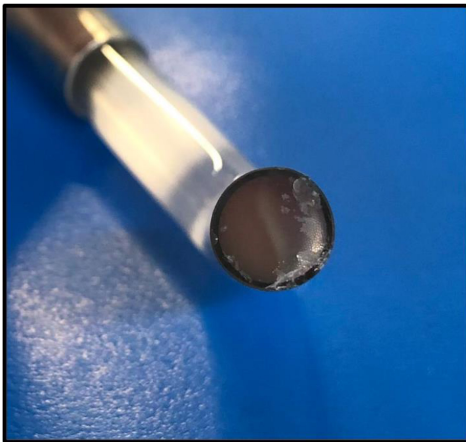
Figura 8: Presencia de resina compuesta polimerizada en la superficie de la punta de la unidad
