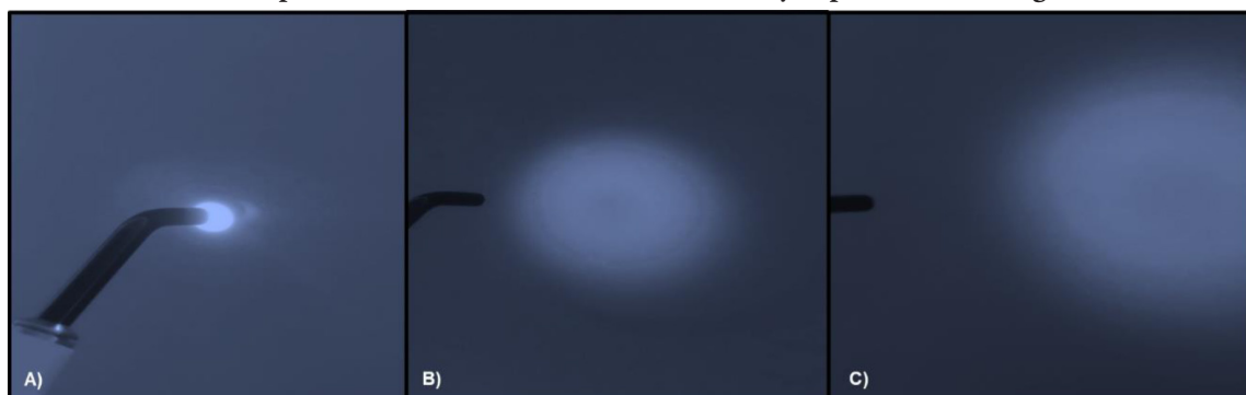
Figura 7: Unidad de polimerización colocada a diferentes distancias de la superficie; se puede apreciar el aumento del área de exposición, la disminución de su intensidad y la pérdida de homogeneidad
