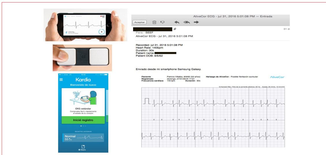
Figura 3. Sistema KardiaMobile de Alivecor®. A izquierda y de arriba abajo, celular, dispositivo y pantalla inicial de la app. A derecha, archivo pdf originado.
