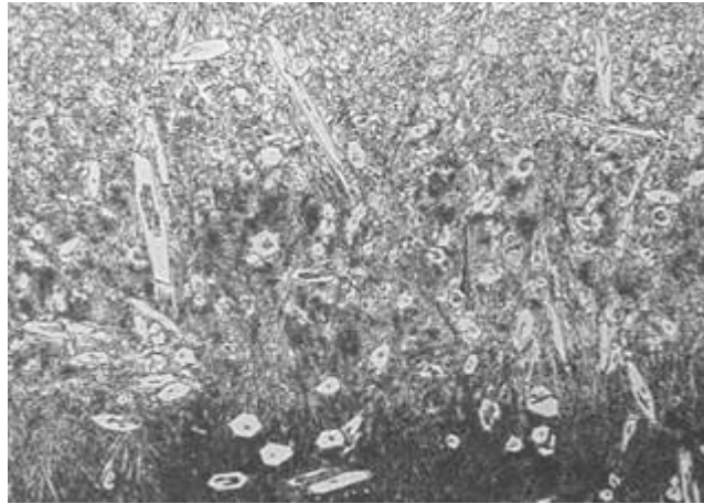
Figura 8 Metalografía ultima capa recubrimiento alto cromo. 200x. Nital Fuente: Los Autores.
