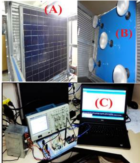
Figura 7 Sistema fotovoltaico. (A) Panel fotovoltaico Atersa. (B) Banco de lámparas para emulación de la irradiación. (C) Sistema embarcado desarrollado.
