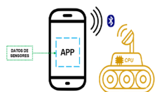
Figura 3. Esquema de funcionamiento de la App para recopilar datos de los sensores y transmitir al robot. Fuente: los autores.
