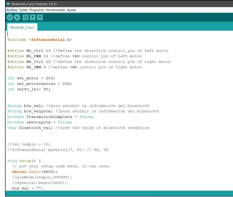
Figura 12. Programación para tarjeta Arduino Nro. 1. Fuente: los autores.
