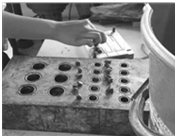
Figura 3. Probetas para el ensayo de abrasión
