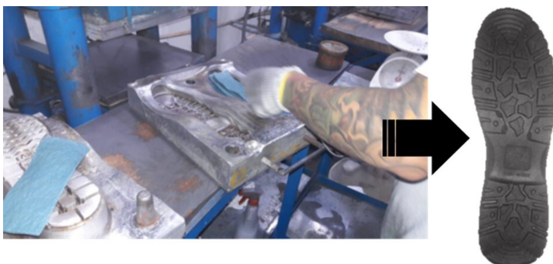
Figura 2. Molde y modelo diseñados para el proceso de conformado
