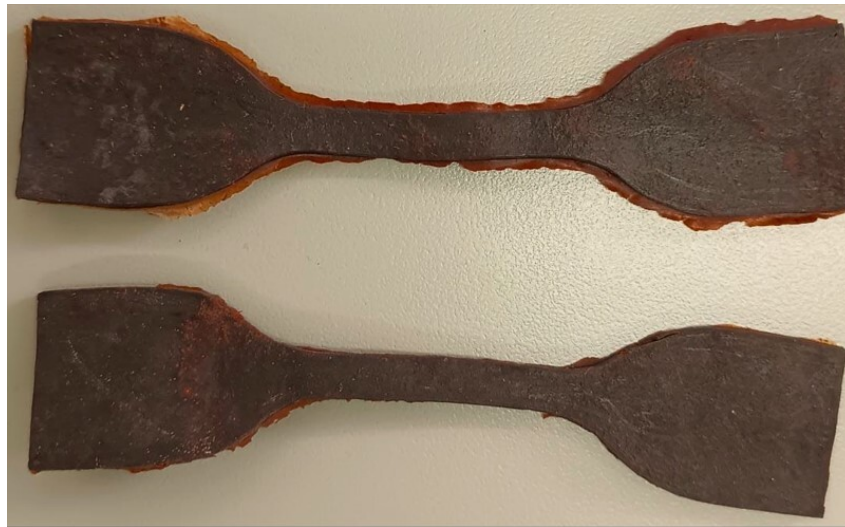
Figura 5. Probetas para el ensayo de tensión
