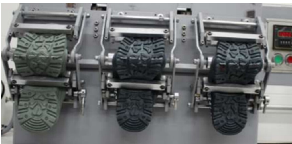
Figura 4. Ensayo de flexión para suelas
