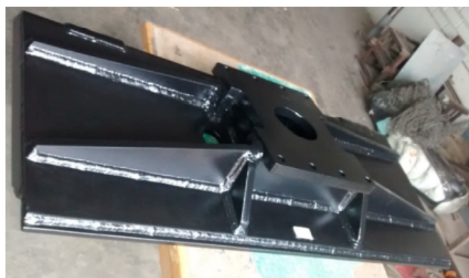
FIGURA 15. Placa de adaptación como producto final
