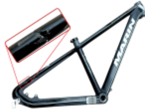
Figura 1. Falla en vainas superiores
