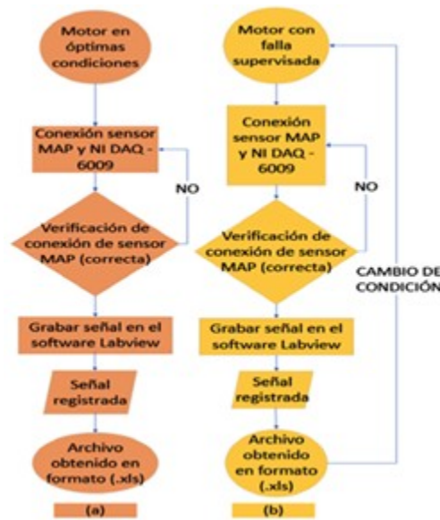
Figura 4. Diagrama de flujo para el proceso de toma de muestras: (a) motor con óptimas condiciones, (b) motor con falla inducida
