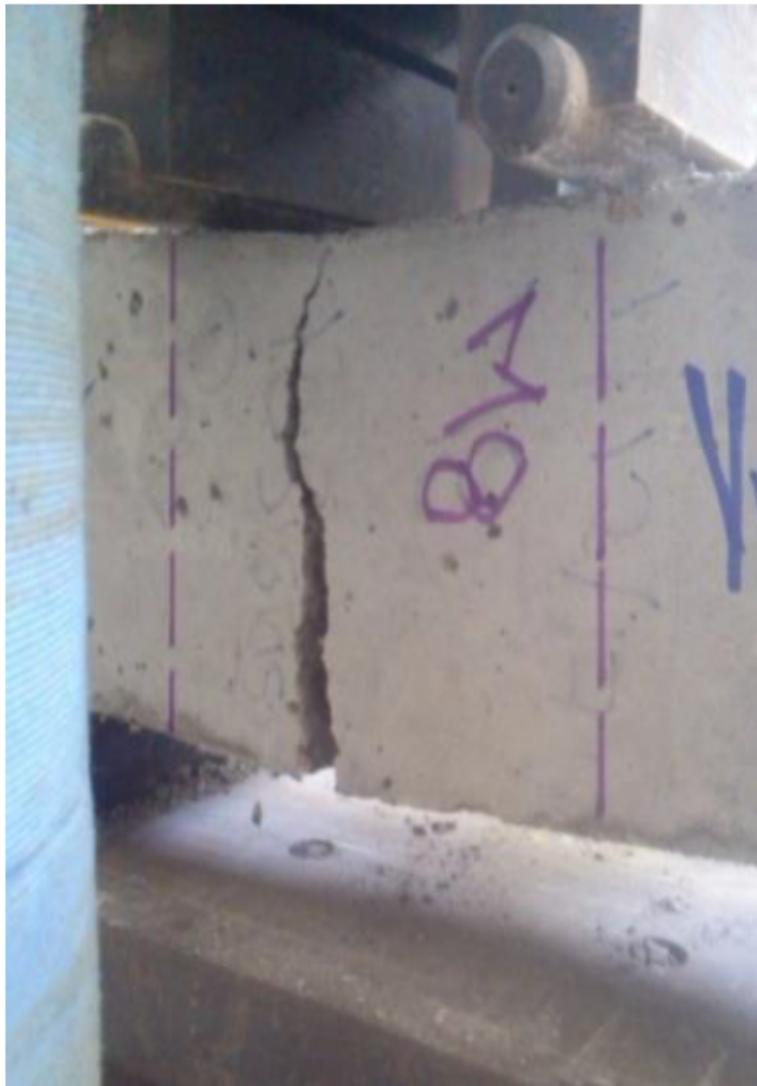
FIGURA 3 Falla de la briqueta en el tercio central
