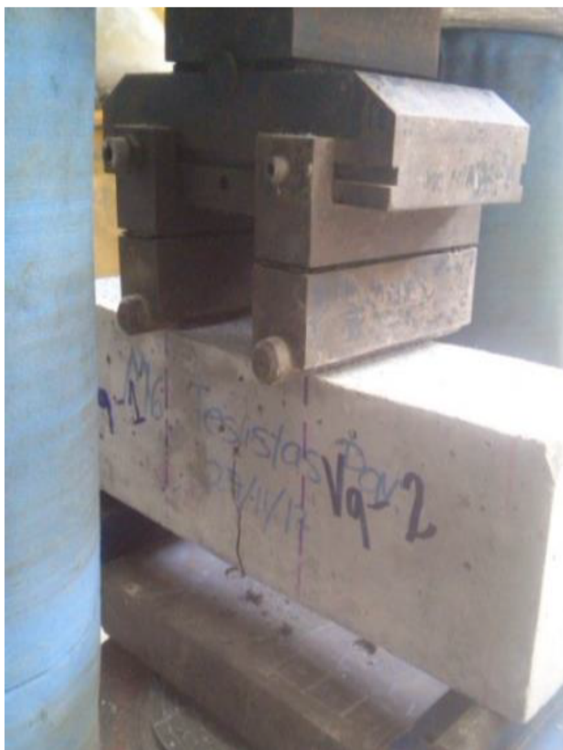
FIGURA 2 Colocación adecuada de la briqueta
