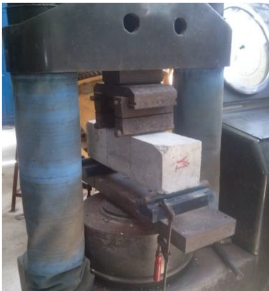
FIGURA 1 Briqueta en la Maquina Universal
