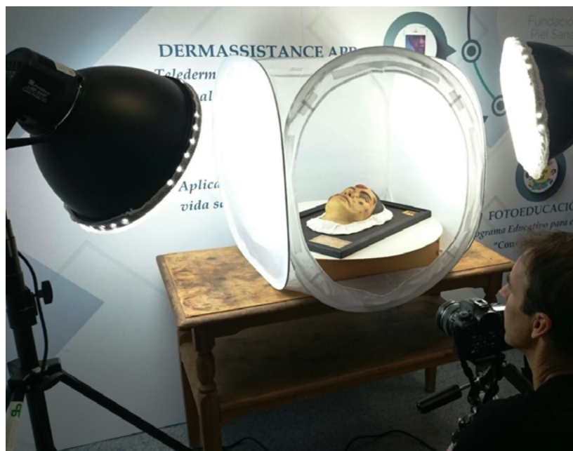
Figura 1. Captura fotográfica con modelo ubicado sobre plataforma giratoria dentro de una caja de luz iluminada por dos focos
