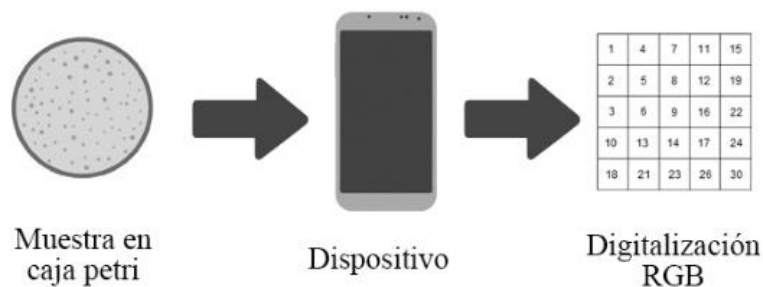
Figura 4. Esquema del funcionamiento de la etapa de adquisición de datos
