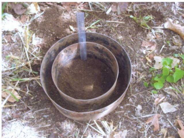
De acuerdo con la norma ASTM D3385-94, el intervalo de velocidad de infiltración para el cual es válida esta prueba es entre  $1 \times 10^{-6}$  cm/s a  $1 \times 10^{-2}$  cm/s.
