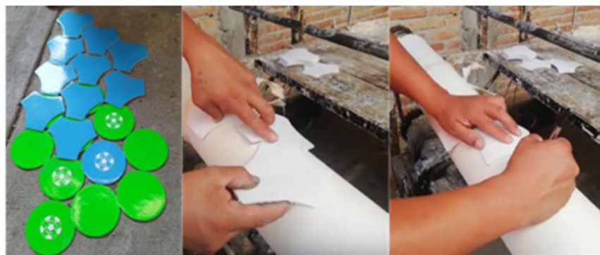
Construcción de patrón con gajos
