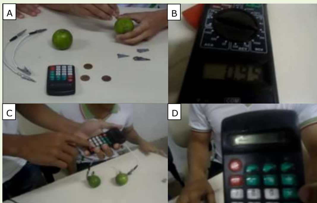
FIGURA 5 – Imagens das etapas de montagem da pilha e seu uso para o funcionamento da calculadora.
