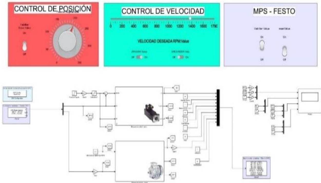
Figura 8. Interfaz HMI en Matlab.
