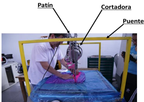
Figura 7. Prototipo del módulo de corte. Fuente: elaboración propia.
