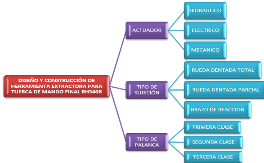
Figura 6. Estructura funcional de la herramienta. Fuente: elaboración propia.
