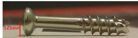
Figura 6. Desfase entre el tornillo y la hoja del patrón de calibración.
