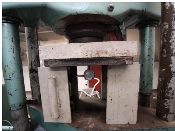
Figura 9. Montaje ensayo NTC 5721
