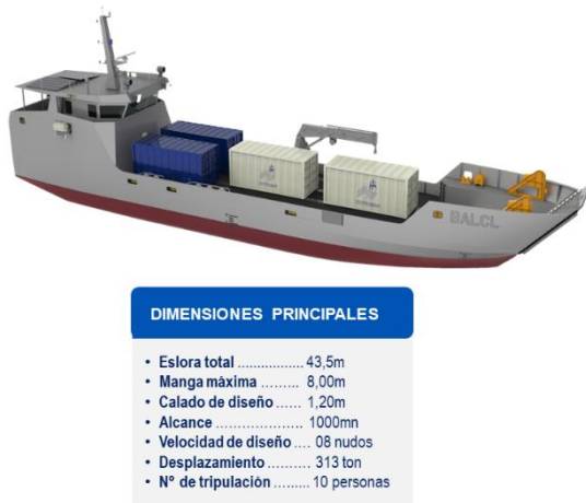
Figura 1. Dimensiones principales de Buque de apoyo logístico y cabotaje liviano BALC-L. Fuente: elaboración propia.
