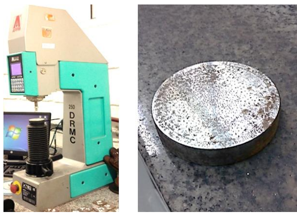
Figura 2. Equipos para medición a) Durómetro AFFRI 250 DMRC, b) Bloque patrón de calibración
