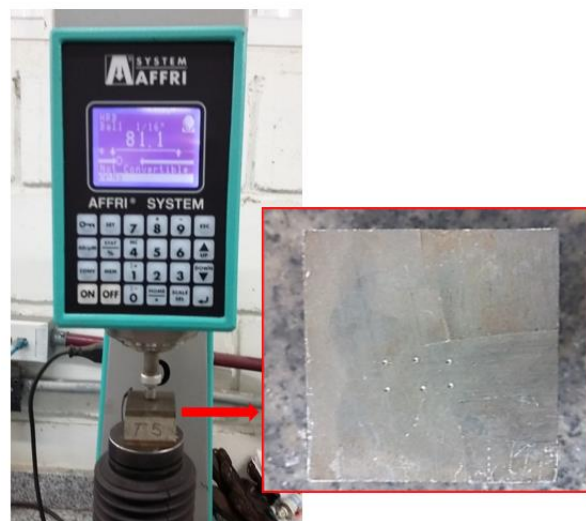
Figura 3. Medición de dureza.
