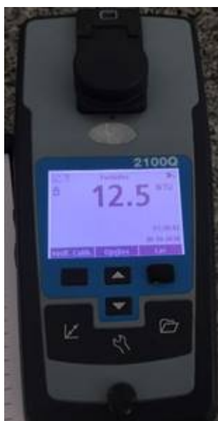
Imagem 8: Medição de turbidez para água residencial Fonte: Autores, 2018
