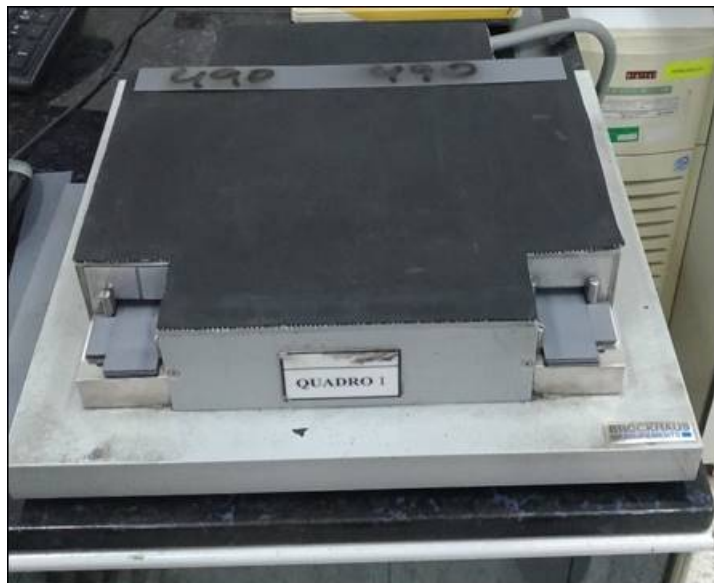
Figura 11 – Aparelho Epstein. Fonte: Autores (2018)
