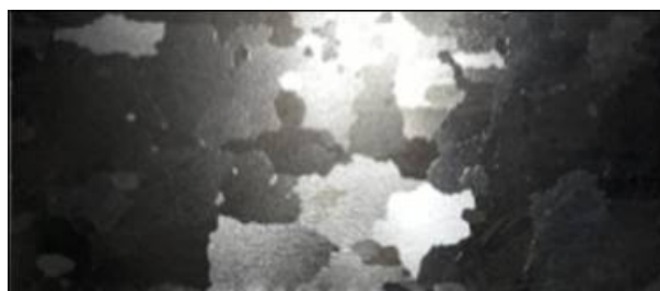
Figura 10 - Grãos Macroscópicos Após o Recozimento. Fonte: Autores (2018)
