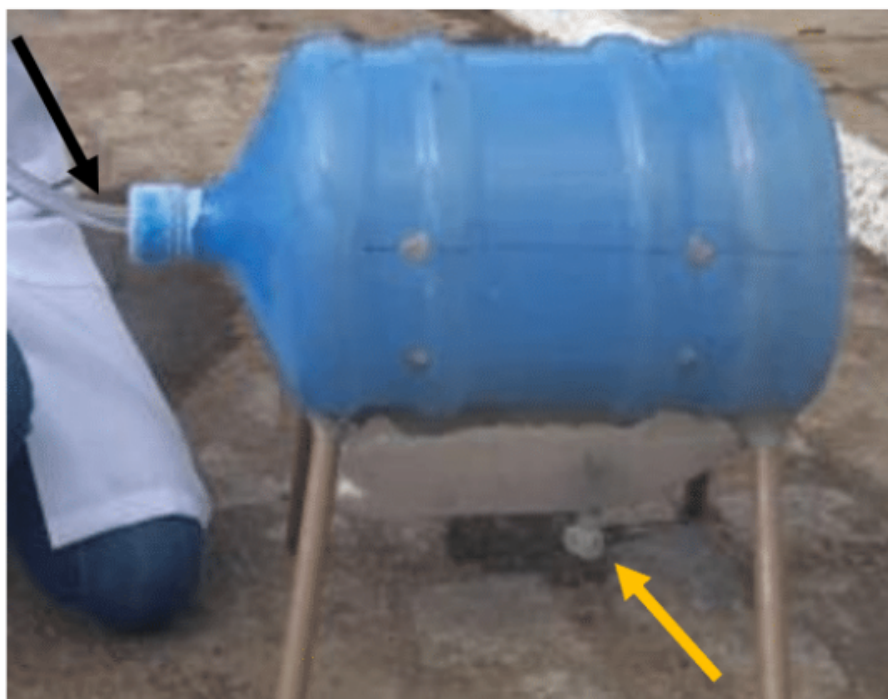
Figura 7. Destilador pronto para funcionamento Autores (2019)
