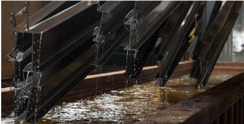
Figura 7 – processo de galvanização do aço
