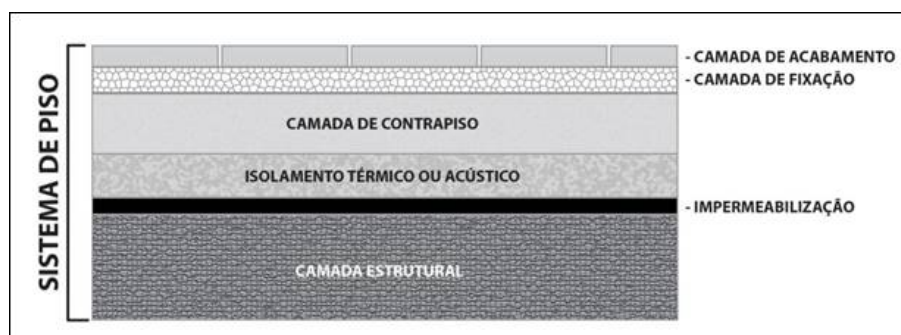
Figura 4 - Exemplo genérico de um sistema de pisos e seus elementos FONTE: ( ABNT NBR 15.575;2013-3)
