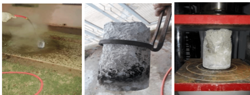
Figura 10 - Concreto antes de iniciar a ruptura efeito sloughing e Spaling Autoria própria (2019).
