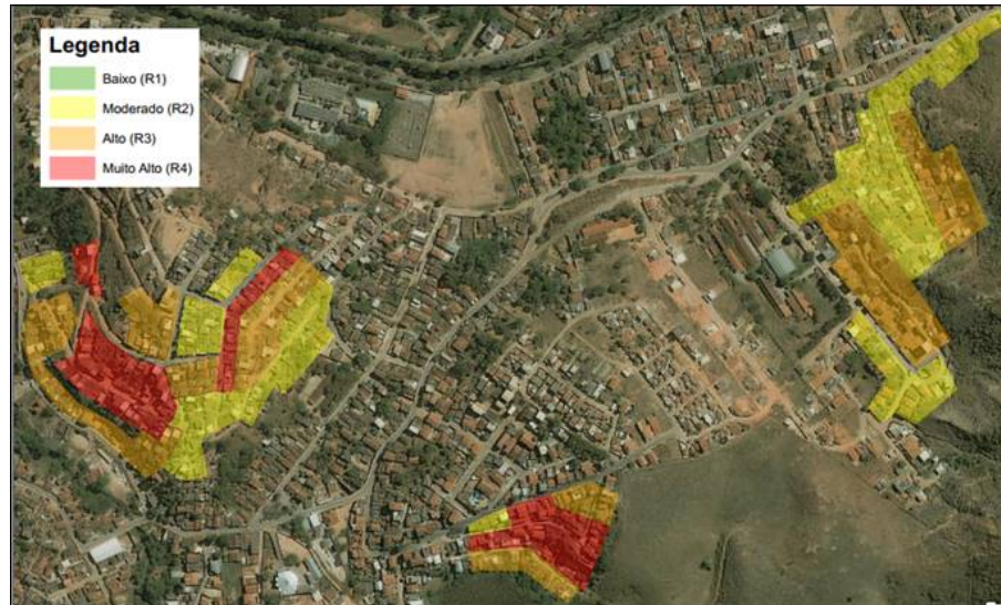
Figura 8 - Carta de Risco a deslizamento planar do Bairro Vila São João.
