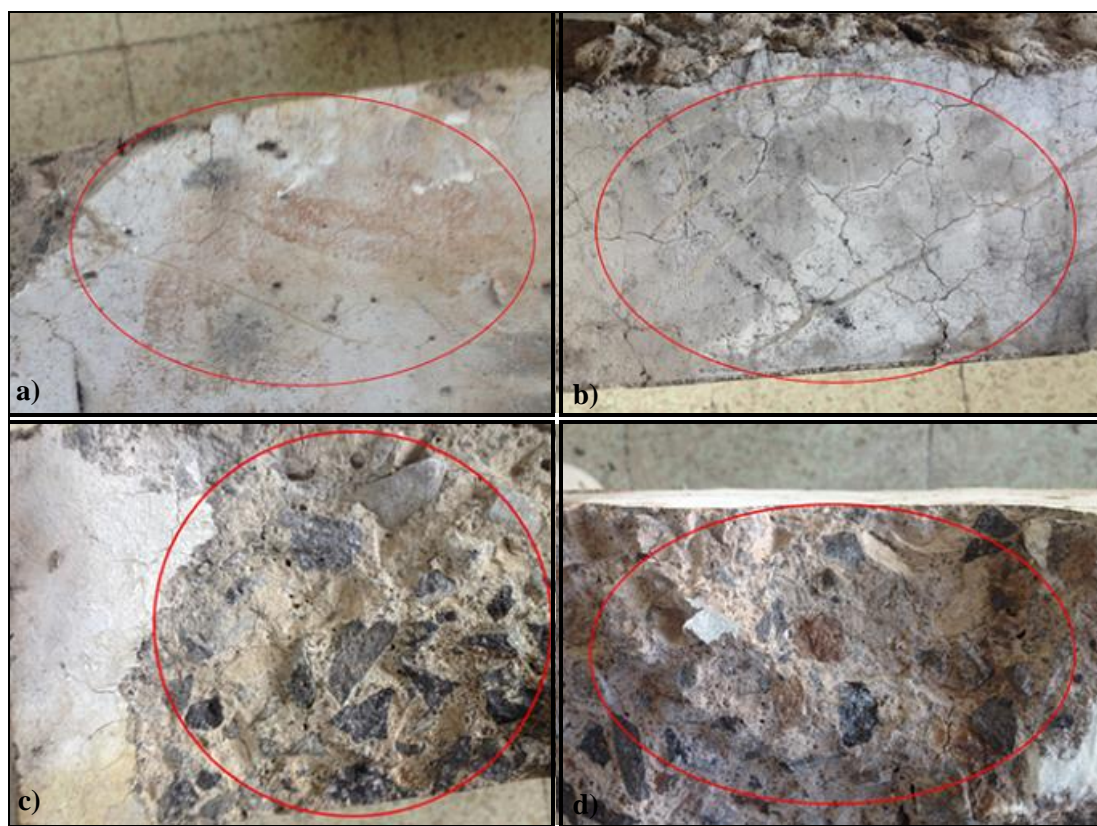
Figura 5. Daños producidos en las vigas de hormigón armado después de los diferentes tiempos de exposición al fuego: a) 30 min, b) 60 min, c) 90 min, d) 120 min
