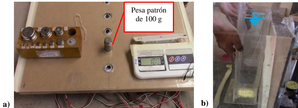
Figura 10. a) Verificación de funcionamiento de sensores con una pesa patrón de 100 g; b) Determinación de la presión hidrostática. Fuente: [7]
