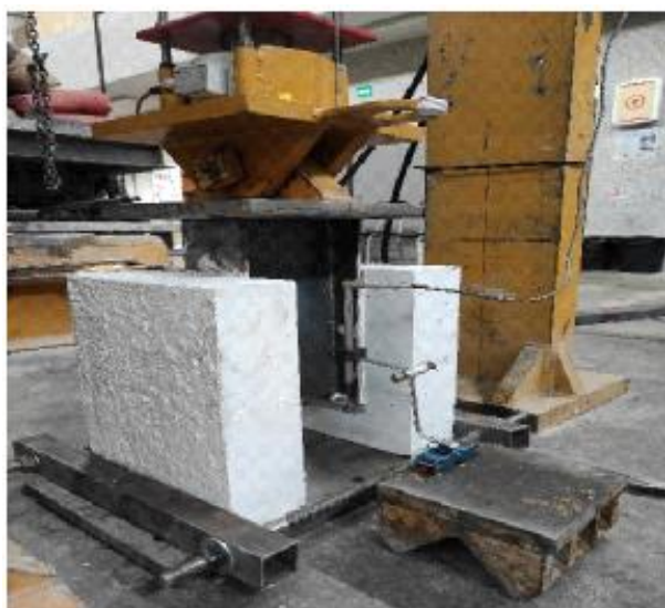
Figura 7. Instrumentación de la probeta. Fuente: [4]
