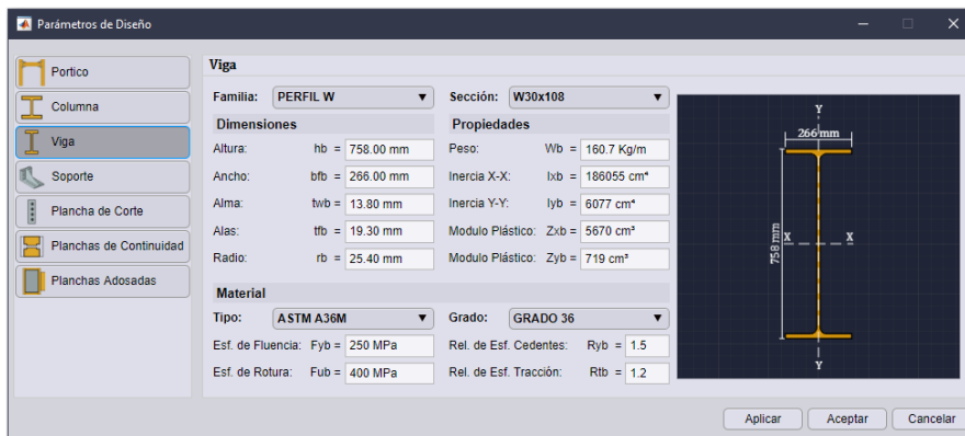
Figura 5. Definición de datos de viga. Ejemplo KBB Serie – B. Fuente: los autores
