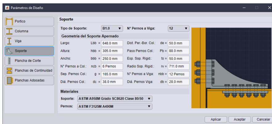
Figura 6. Selección de tipo de soporte y materiales. Ejemplo KBB Serie – B. Fuente: los autores
