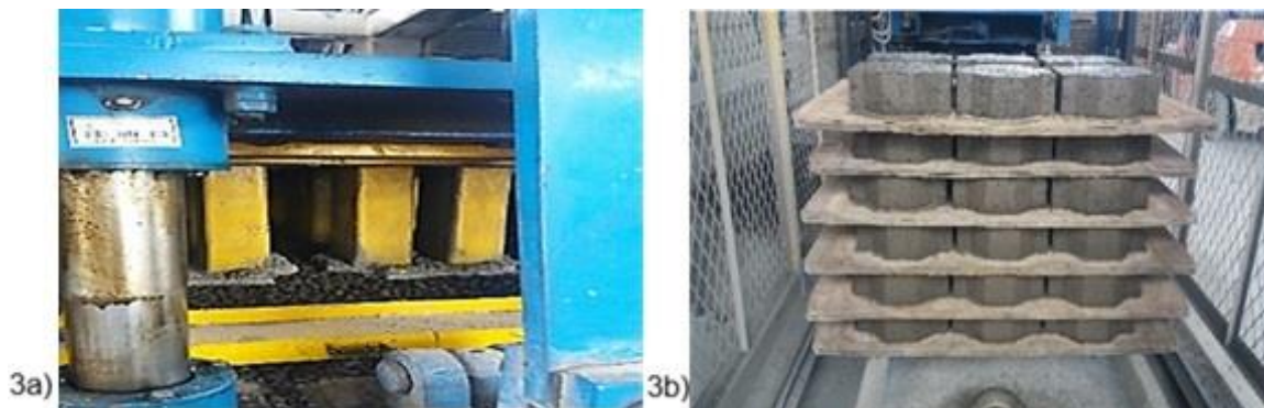
Figura 3. 3a) Compactación en la mezcla de hormigón con partículas de caucho reciclado. 3b) posicionamiento de muestras sobre el tablero. Fuente: los autores
