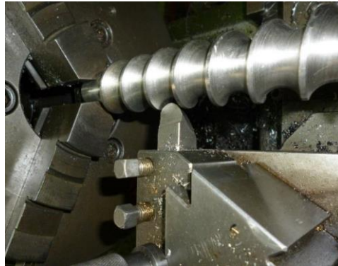
Figura 3. Maquinado del tornillo extrusor
