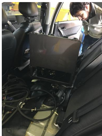
Figura 2. Instalación on-board del equipo de medición de emisiones Axion OEM-2100AX
