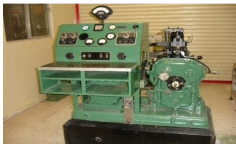
Figura 1. Equipo de medición de octanaje (Octanómetro)
