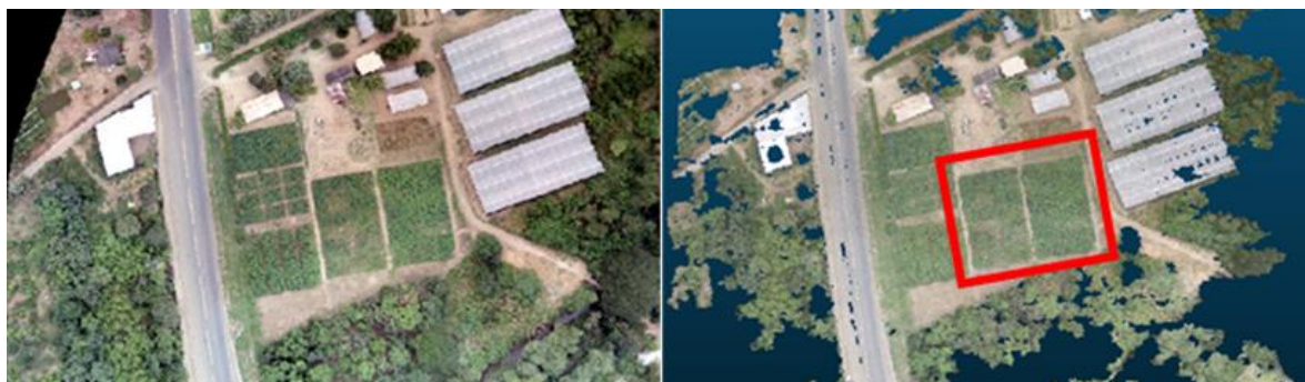
Figura 5. A la izquierda la ortofoto que muestra un cultivo experimental de algodón y a la derecha la nube de puntos, resaltando en rojo las parcelas de interés.
