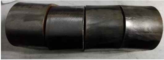
Figura 7. Muestras de doblez. De izquierda a derecha, la muestra de doblez de cara del electrodo AWS E6013 y la del experimental (a), le siguen las de doblez de raíz en igual orden
