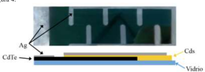
Figura 4. Detalles del diseño de la celda de p-CdTe/n-CdS. En la parte inferior, el arreglo experimental utilizado en este trabajo. En la parte superior, fotografía de la celda ya realizada.
