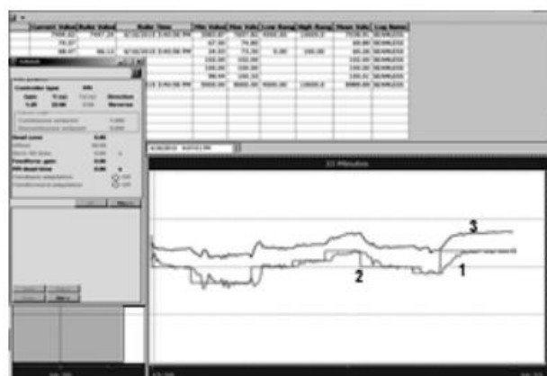
Fig.10. Respuesta del controlador Predictor Smith y flujo de alimentación de la torre
