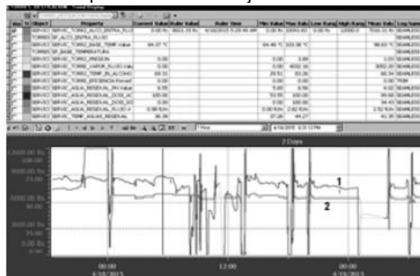
Fig.13. Control PI planta de flujo antes de la optimización.
