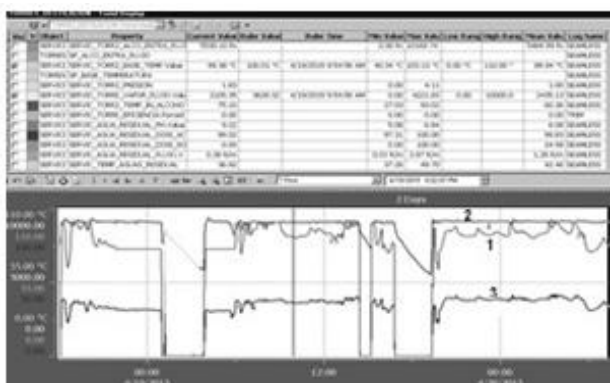
Fig.11. Control PI planta de temperatura antes de la optimización
