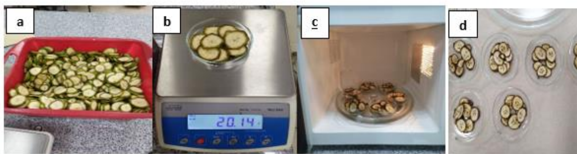
Figura 2. Proceso para la obtención de porcentaje de MS de rechazo de verde ( Musa × paradisiaca ) en horno microondas. a] Verde picado en rodajas. b] Pesaje de las muestras. c] Muestras en el microondas. d] Muestras secas.
